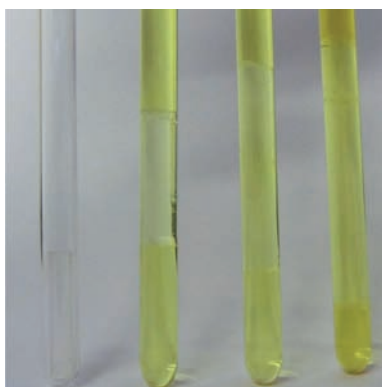
Abbildung 1. Polystyrolstäbchen in einem NMR-Röhrchen (5 mm). Von links nach rechts: Ungequollenes PS-Stäbchen; arretiertes Stäbchen direkt nach der Zugabe der Organolithiumlösung; gequollenes Stäbchen nach drei Tagen und nach sieben Tagen.
